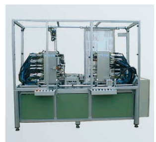
23 Nietmodule zur Montage von Computerchassis
